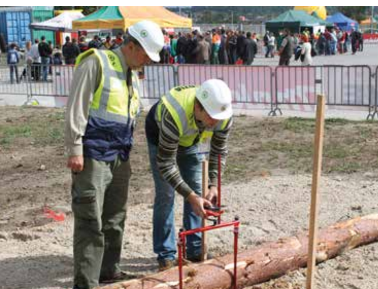
Dalmierz laserowy określa odległość ścietej kłody od palika
