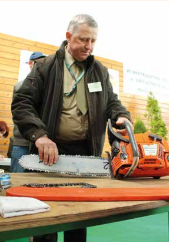
Kontrola techniczna pilarki przed zmianą łańcucha na czas
